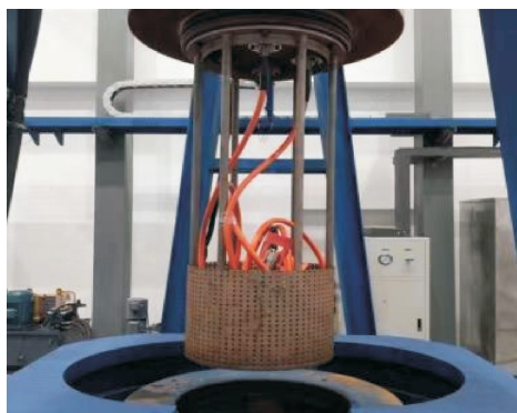
图 13 静水压力试验
