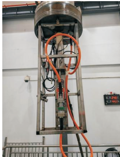
图 2 水下湿插拔光电混装连接器带压水下插拔试验
