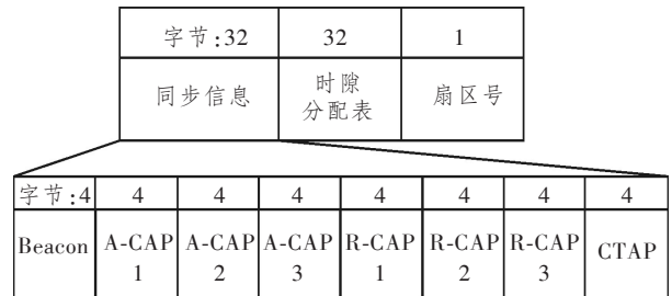
图 4 新型 Beacon 帧结构
