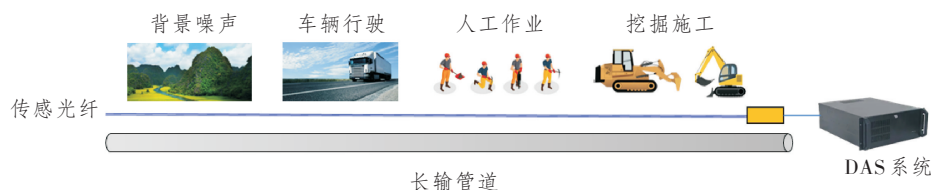
图 1 长输管道与 DAS 系统监测示意图
